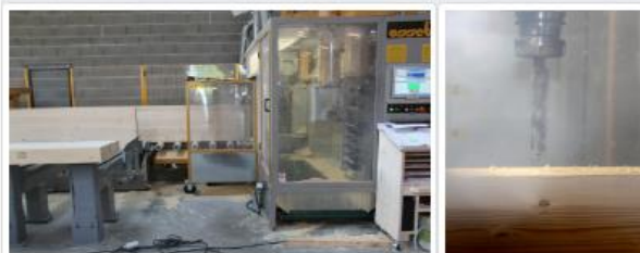
Vissage des connecteurs SBB® dans les poutres pré-perçées.
