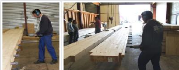
Vissage des connecteurs SBB® dans les poutres pré-perçées.
